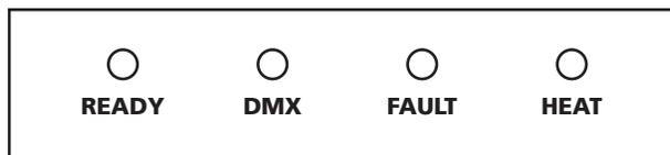
READY: clignoter signifie chauffer, environ 5 min. Passe de clignotant à long, indique que la machine est prête à fonctionner.
