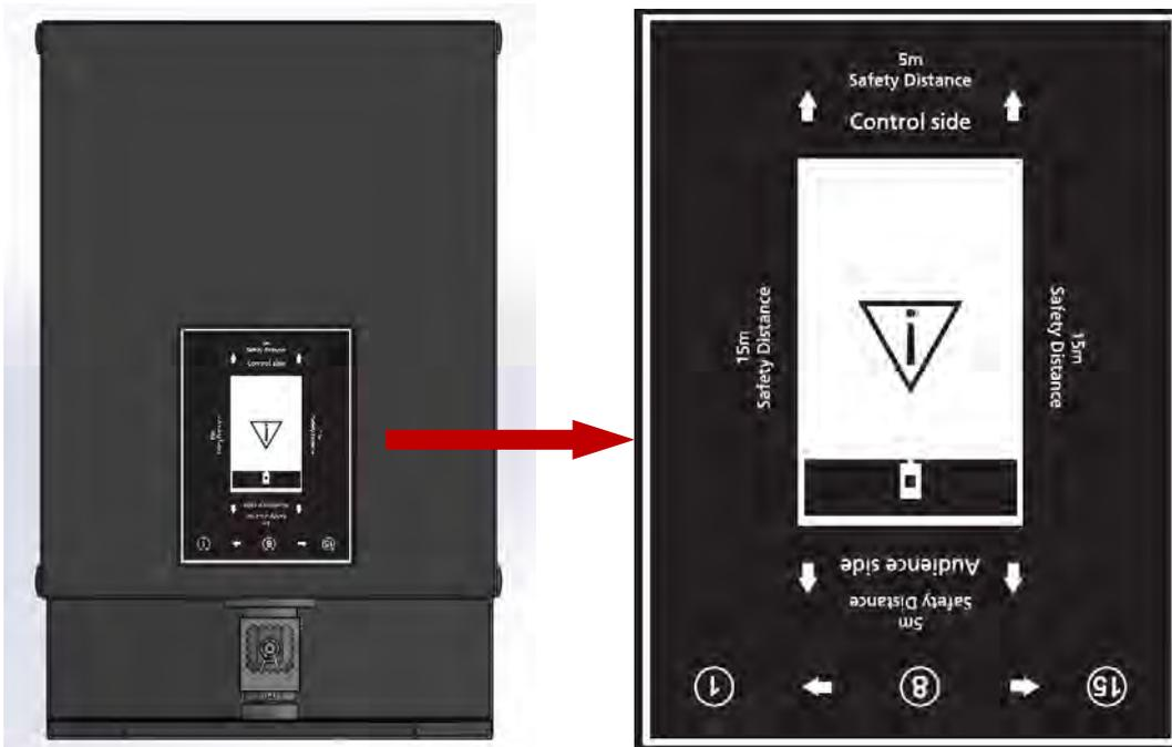
1. 1 à 15 est l'angle de tir du Flamer du cercle, l'extrême droite est la position 15, le milieu est la position 8, à l'extrême gauche est la position 1.
